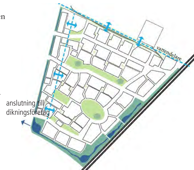
Figur 14. Principerna för avledningen av dagvatten från hela planprogramområdet.
