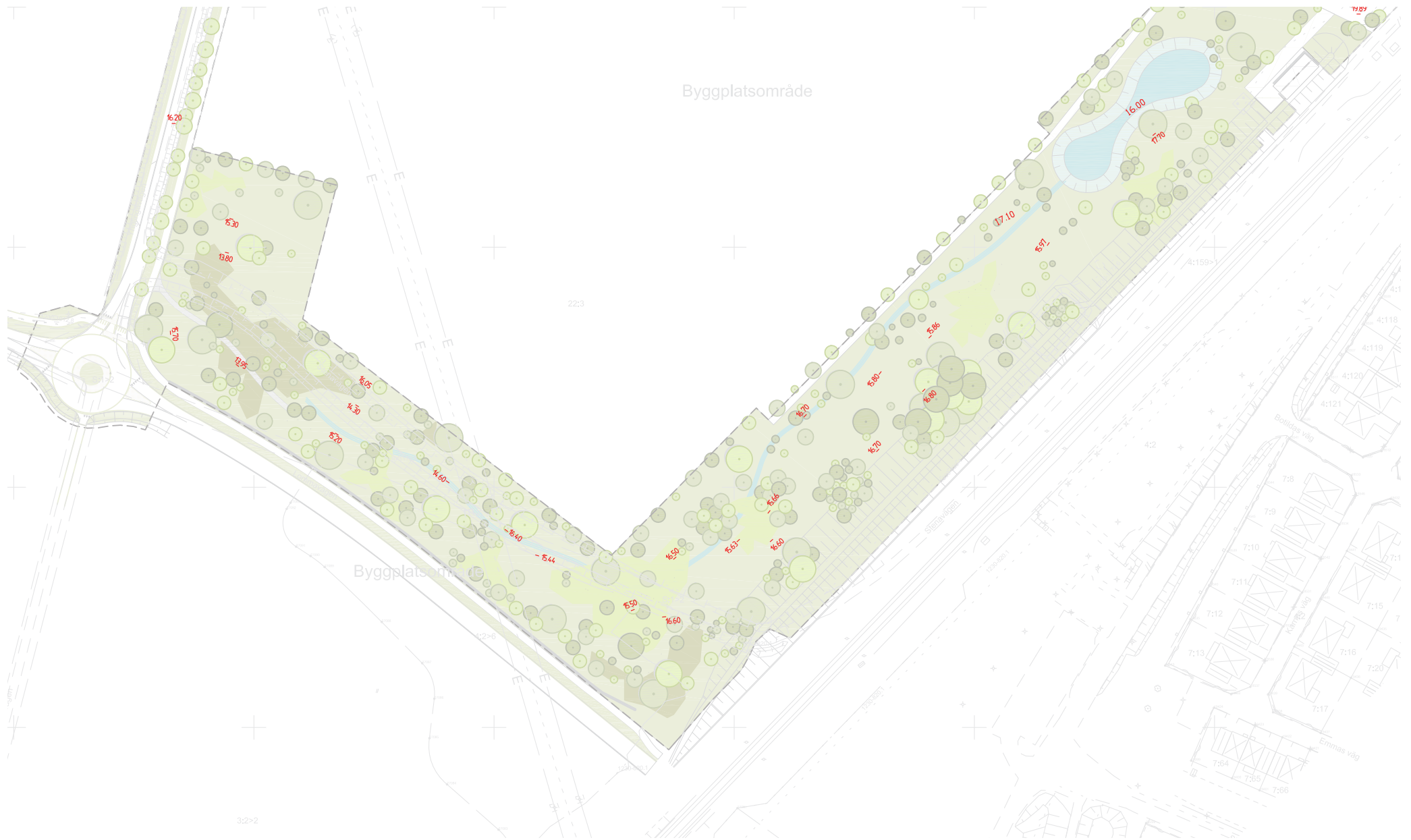
Figur 22. Förprojekterad höjdsättning enligt Skyfallsanalys, Västerstad, slutrapport 2020-09-29. Enligt utredningen kommer höjdsättningen är klara 100-års regn med klimatfaktor. Norra delen (föregående sida) och södra delen av planområdet (denna sida).
